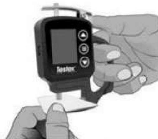
NOTA: Limpiar los yunques antes de encender el medidor, de reiniciarlo (pág. 6) o cada vez que el instrumento no indique  $-50 \mu\text{m}$  ( $-2,0$  mils) al retirar la cinta de réplica tras realizar una medición.
